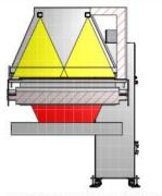
STAZIONE DI ISPEZIONE SUPERIORE CON SISTEMA 3D (CAMERA +LASER)
